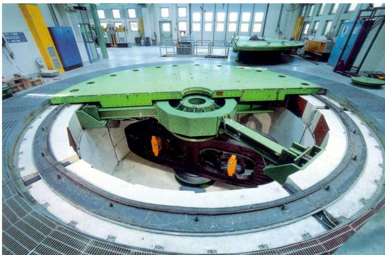
La sperimentazione consiste nell'affiancamento alla costruzione del modello di argine in scala 1 :50, l'installazione dei sensori (circa 1 mese). L'esecuzione dei test (circa 1 settimana). L'analisi dei dati provenienti dai sensori di pressione, dei tensiometri, dei trasduttori di spostamento e dalle riprese video (3 mesi circa).
